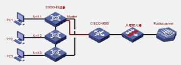
三台S3600交换机作堆叠,在Master上连接cisco 4500,然后连接到天塔防火墙,最终 连接到cams做认证.
