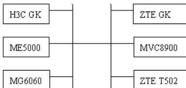
注:一般中兴GK服务器与MCU控制台是安装在同一个PC上的,这里MCU控制台与MCU接口地址不同,远端主机可以通过控制台地址用WEB页面方式登陆控制台,而控制台内部又与MCU接口地址连接实现对MCU的控制功能。
