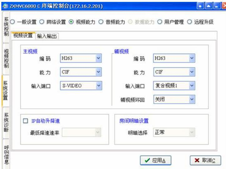
在视频能力—>输入输出设置中选择输入源接口及对应的摄像头控制口。
