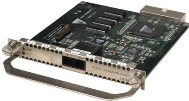
1ATM-OC3SML module panel
