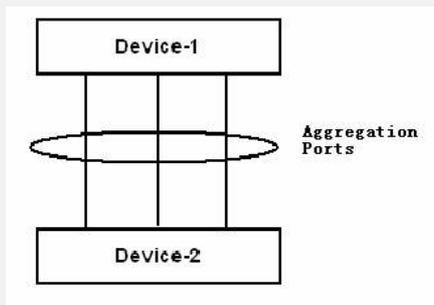
如图，Device-1和Device-2开启IGSP，并配置聚合端口，其中Device-2的上行聚合端口作为IGSP的路由器端口。对Device-2聚合组中其中2个端口频繁进行shut down和undo shut down操作。
