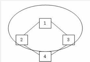
设备1、2、3、4使能MSTP，其中设备1、2、3属于一个MSTP域，设备4属于另外一个域，所有设备只创建实例0，总根为设备1，在设备4上反复配置undo stp instance 0 priority / stp instance 0 priority命令。
