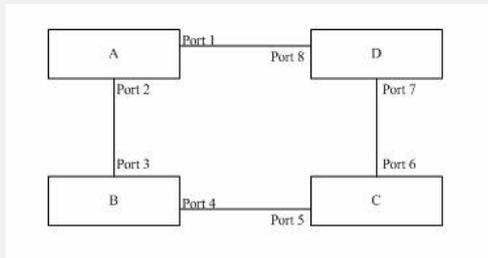
如图，A、B、C、D四台设备属于同一个MST域，A是实例零和某个实例N（N不等0）的根桥，Port 6在实例零和实例N中的角色均为Alternate。此时，将B指定为实例N的根桥，接着再将A重新指定为实例N的根桥。
