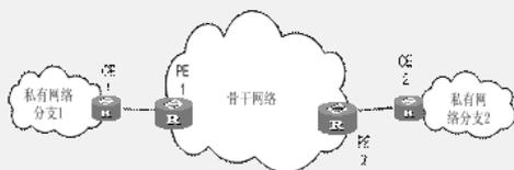
上图为基于MPLS的VPN的基本结构。CE (Customer Edge) 是用户边缘设备；PE (Provider Edge) 是服务商边缘路由器，位于骨干网络；PE负责对VPN用户进行管理、建立各PE间LSP连接、同一VPN用户各分支间路由分派。
