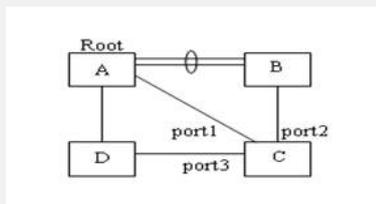
上图四台设备开启STP功能, 反复修改设备C上端口port1的cost值, 在端口port2上执行shutdown命令。
