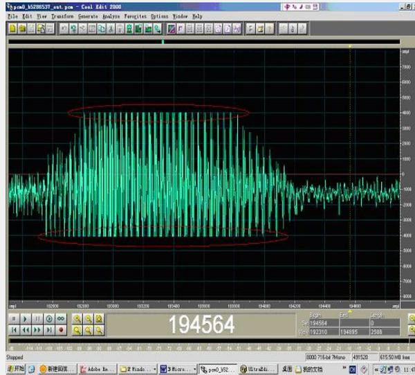
发现XE2000给的提示音幅度过大,饱和了,也同时导致进入FXO口的回音幅度也特别大,二次拨号的DTMF被回音淹没了。所以VG20-08L没能正确的检测出被叫号码,于是通过COOLEEDIT把XE2000上的文件的声音和背景音乐的幅度都调小了,调整后,经过多次的测试,再也没出现“号码不存在”的情况了。
