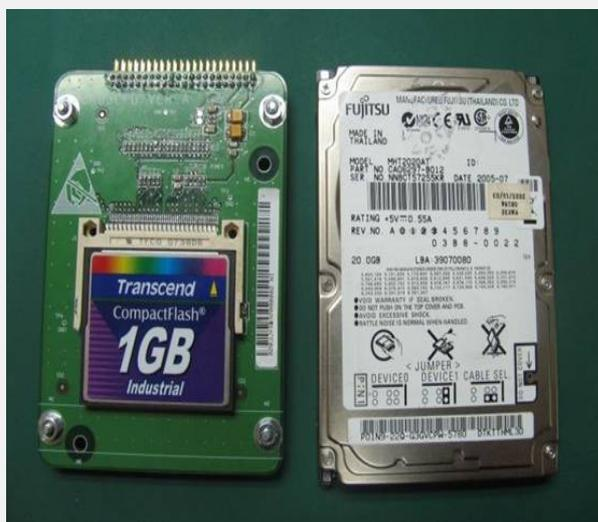
NE40/NE80/S8016产品从2007年4月起发货的新主控板SRUE/MPUF已经将硬盘更换为CF卡。本次公告的对象为SRUB、MPUB等老主控板（具体见表1），自2008年4月开始申请的老主控板将使用CF卡。自公告发布之日起，NE40/NE80/S8016现网运行的主控板，如果硬盘有损坏，要求使用CF卡进行现场更换，不再返回总部处理。具体更换方法请参照《NE40/NE80/S8016产品现场使用CF转接卡更换主控板失效硬盘操作指导书》。现场更换操作简单，更换为CF卡的主控板可以继续使用，从而降低单板周转成本和由此产生的运输风险；使用CF卡后主控板的可靠性增强，可以减少一线工程师的维护投入；另外CF转接卡小巧轻便，比主控板容易携带，方便带到现场更换。
