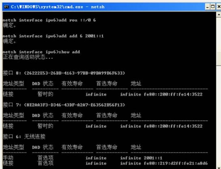
4、选择连接SSID“H3C-IPv6”，此时客户端可ping通AC和AP的IPv6地址2001::11和2001::22。
