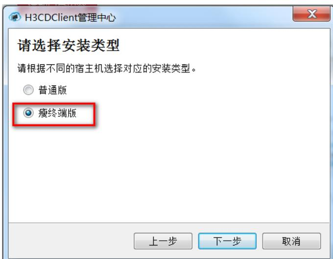
注意这里的安装类型必须为瘦终端版，这是由于瘦终端版的安装方式，会屏蔽底层的操作系统。瘦客户机开机后直接进入客户端程序，而普通版的安装方式中，客户端程序以操作系统的另一个应用程序的方式存在，与本案例中的使用场景不符。
