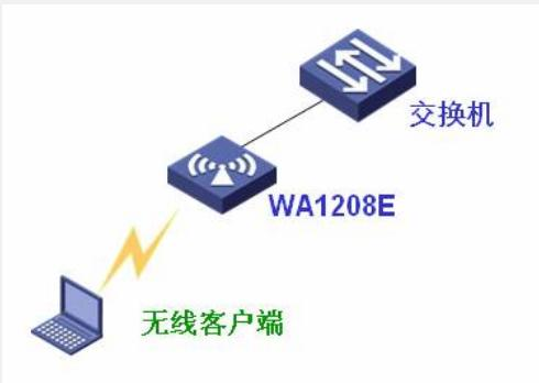
当WA1208E的以太端口出现故障断开时，WA1208E将自动检测到有线端口的故障，并且自动断开无线端口的所有终端与自己的连接，释放连接上的终端用户。
