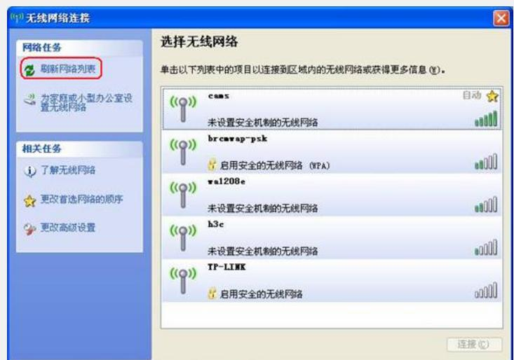
b、选择SSID cams进行连接，使SSID cams的状态变为“已连接上”，如下图所示。（本例中的Windows无线客户端配置了静态IP地址192.168.0.99，所以SSID cams的状态可为“已连接上”；如果Windows无线客户端配置的是自动获取IP地址，那么在选择连接SSID cams后将无法获得IP地址，提示为“受限制或无连接”）
