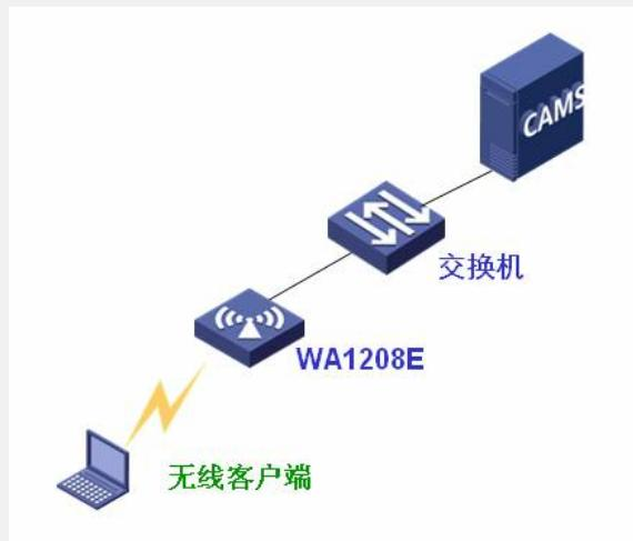
CAMS服务器的IP地址为192.168.0.10，WA1208E的IP地址为192.168.0.50，无线客户端配置静态IP地址192.168.0.99，使用的SSID的名称为cams。
