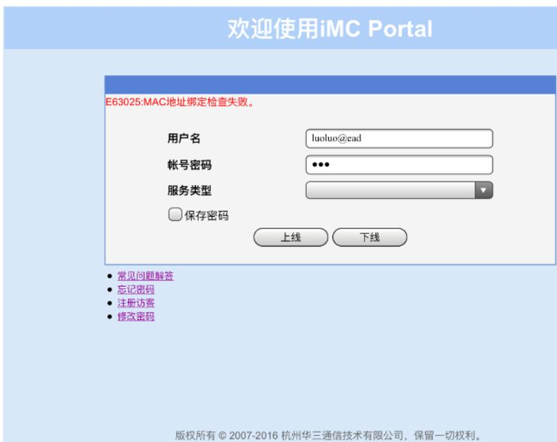
认证失败，提示MAC地址绑定检查失败。通过上述实验我们能够分析出，当接入策略里同时启用绑定用户MAC地址和启用终端MAC地址控制两项功能时，绑定用户MAC地址的优先级高于终端MAC地址控制。当接入用户的绑定信息中用户MAC地址没有被绑定时，即使在终端MAC地址为允许接入且配置了终端MAC地址列表时，终端仍然无法认证通过。
