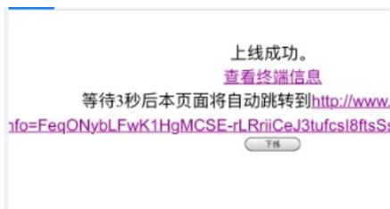
(2) 在终端MAC地址池中再添加一个终端MAC地址，根据MAC地址自学习数量为1的设置，使用刚刚添加的终端进行认证测试，使用与测试效果如下：
