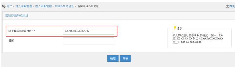
此案例中手工添加某一终端的终端MAC地址，当终端MAC数量过多时，可以采用批量导入接入MAC地址的方法将一定量的接入MAC地址导入MAC地址列表中。如下图所示：
