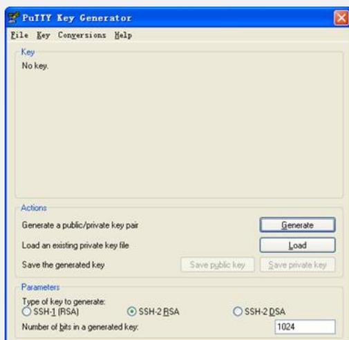
在产生密钥对的过程中需不停的移动鼠标，鼠标移动仅限于下图蓝色框中除绿色标记进程条外的地方，否则进程条的显示会不动，密钥对将停止产生。
