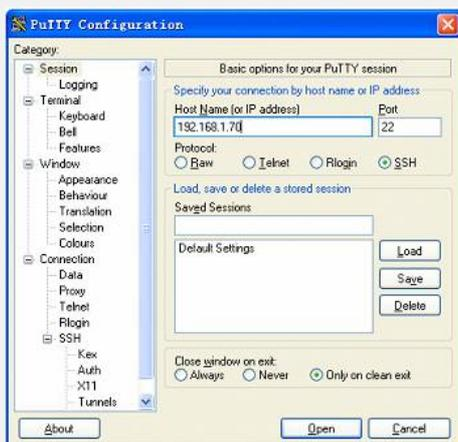
在“Host Name (or IP address)”文本框中输入SSH服务器的IP地址。
