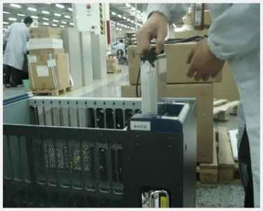
3) 用手抓紧中间的钣金件,用力拔出,如下图所示。操作完成后注意将机箱放正。不能抓住电源框拉手,会导致拉手损坏。
