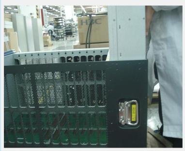
2) 电源模块插入插槽后,垂直向下用力压,就能将电源模块插入,如下图所示。装配 完毕后注意锁紧相关螺钉,请机箱放正。
