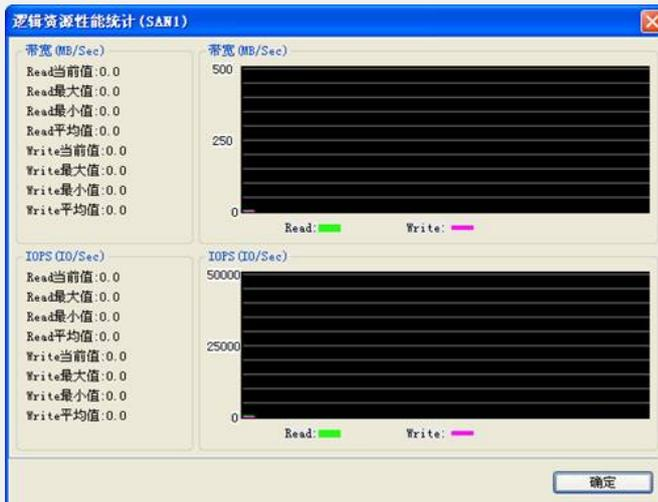
5、在窗口中可以看到选择的逻辑资源的实时带宽以及实时IOPS,以及最大、最小值和平均值。点击[确定],关闭性能统计
