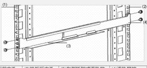
(1)机柜前方孔 (2)机柜后方孔 (3)左侧托架式滑轨的 (4)滑轨尾端 条 条 托片
