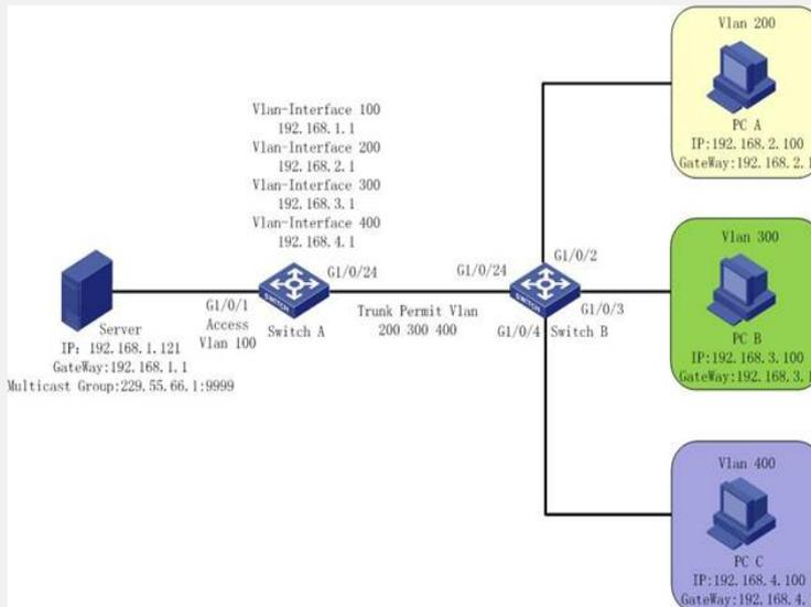
Switch A端口1连接组播源, 端口24连接下行二层设备。
