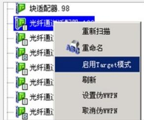
如果如下图的“模式”栏中显示为“target”，并且光纤通道适配器显示“T”的标识，则表示FC端口为普通模式。
