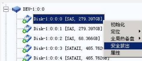
2. 系统将对该磁盘安全下电, 需要等待30秒; 30秒后磁盘黄灯、绿灯均以0.5Hz频率闪烁, 此时可以拔出磁盘。
