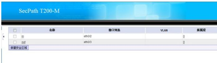
如下图所示，在端口划分区域界面可设定vlan，可以只允许添加的vlan数据进入端口并接受，如果勾选方框可以设定vlan的范围。不设定vlan，默认是所有数据。
