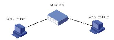
ACG1000处在IPV6网络当中,设备上将两个物理口加到一个桥口bvi口当中,让这个接口透传两侧通信 的ipv6报文,报文已经发往ACG1000设备,但是业务不通,被ACG1000丢弃。
