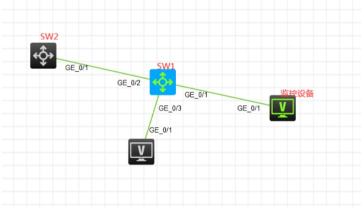
假设在SW1部署本地端口镜像，监控去往SW2设备的流量，因此需要将G1/0/2端口设置为镜像口，监控进出流量；同时将G1/0/1口设置为监控口，链接着监控设备。G1/0/3端口作为业务的接入。
