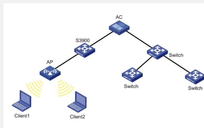
本配置举例中的AC使用的是WX5002无线控制器，AP使用的是WA2100无线局域网接入点。无线客户端Client1和Client2通过无线局域网络连到无线控制器AC上。
